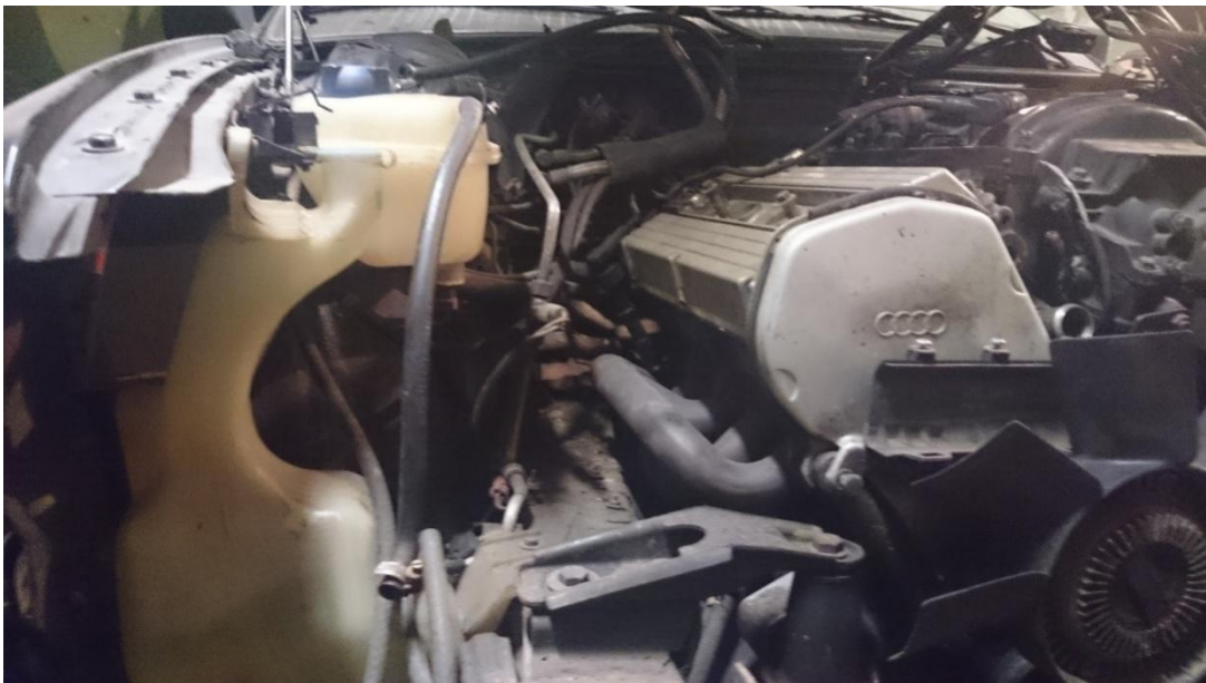
Sele15. Võimalik turbokompressori asukoht.
