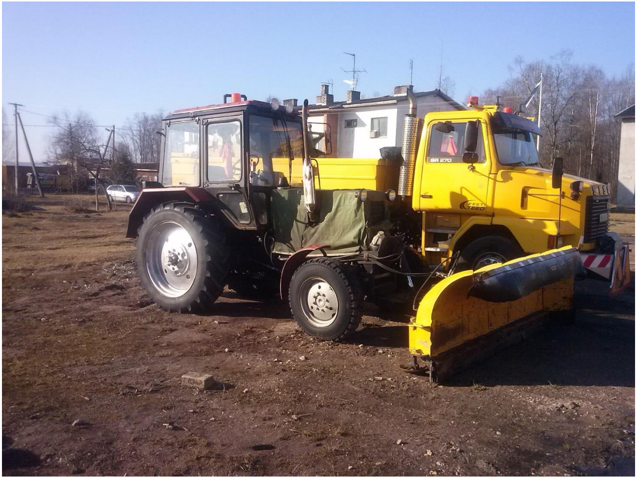
Foto 5. Esisahaga varustatud traktor MTZ [5]
