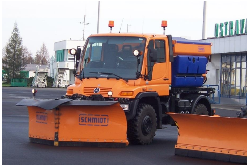
Foto 6. Esisaha ja soolaliivapuisturiga Unimog [6]
