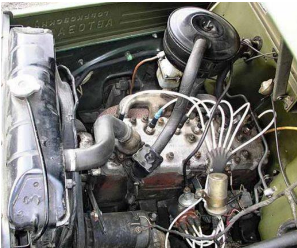
Pilt 2. GAZ-51 originaal mootor [16]
