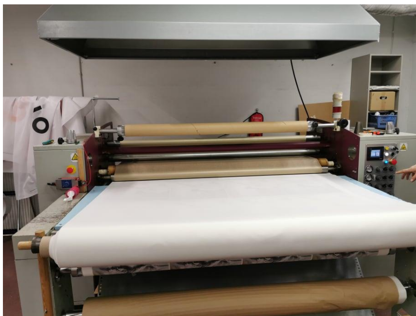
Joonis 25. Sublimatsiooni siirdepaberilt kujutise pressimine kangale
