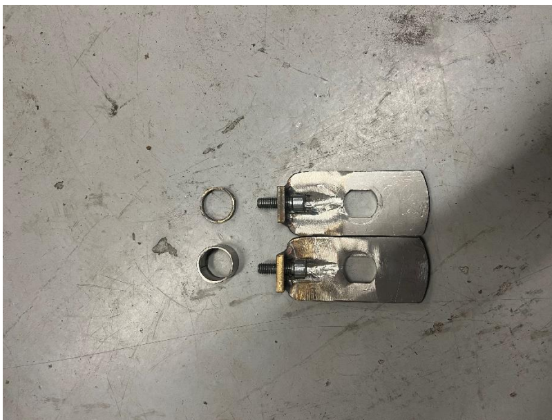
Sele 25. Valminud rummumootori kinnitusplaadid koos distantspuksidega
