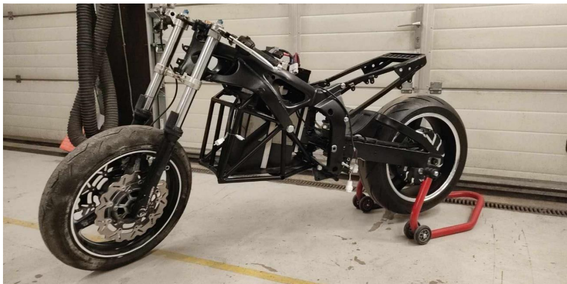
Sele 26. Elektriliseks ümber ehitatud Yamaha YZF-R6 mootorratas
