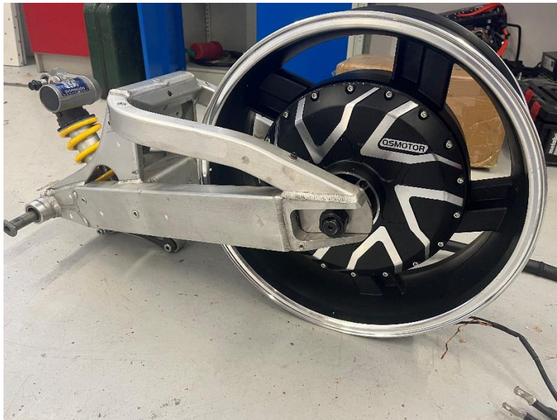
Sele 23. Kiige kinnituskohade vahele paigutatud rummumootor
