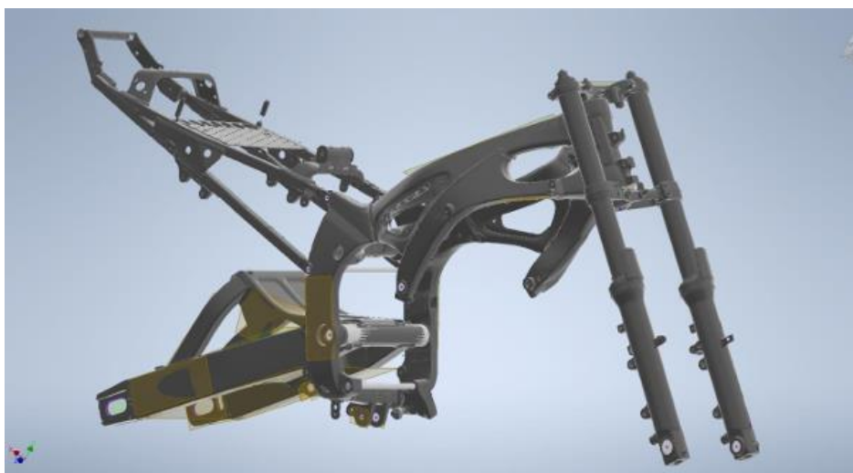
Sele 9. 3D skaneeritud mootorrattas 3D modelleerimise tarkvaras
