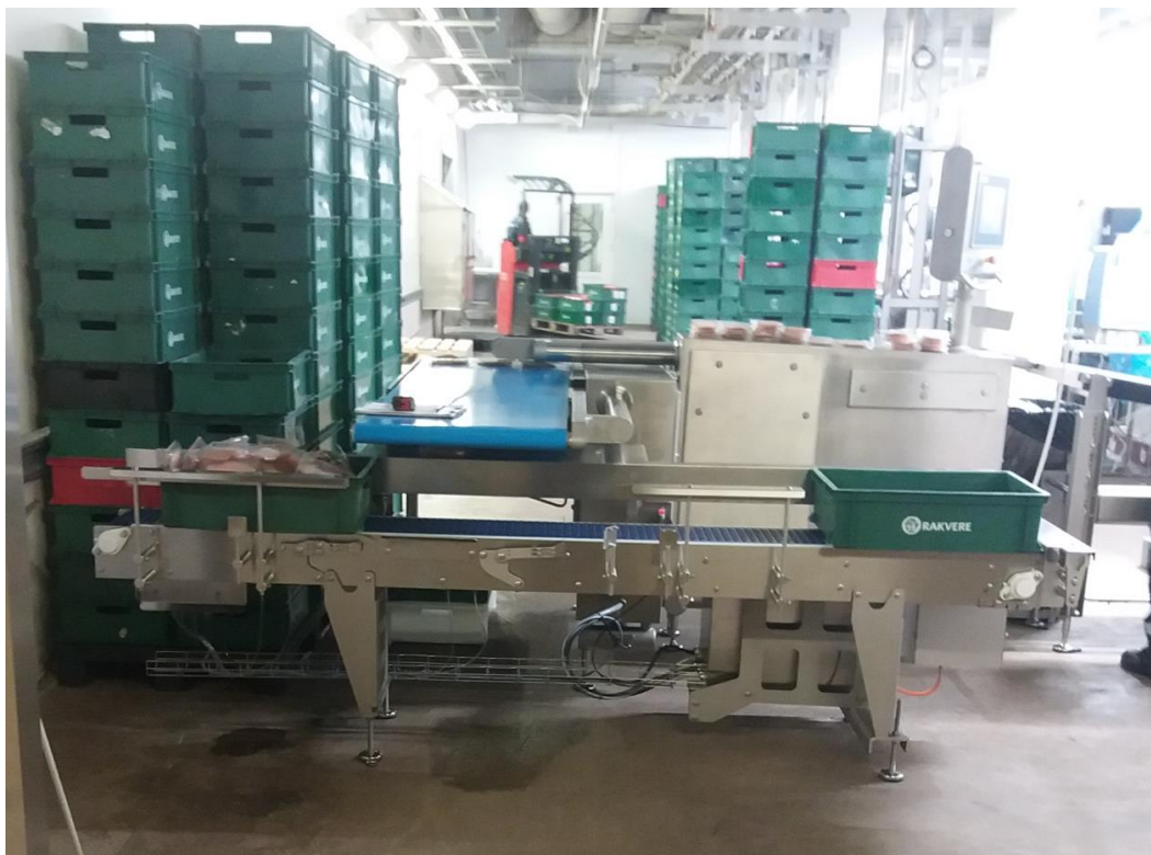
Joonis 1. Viilutusliin koos konveieriga (autori foto)
