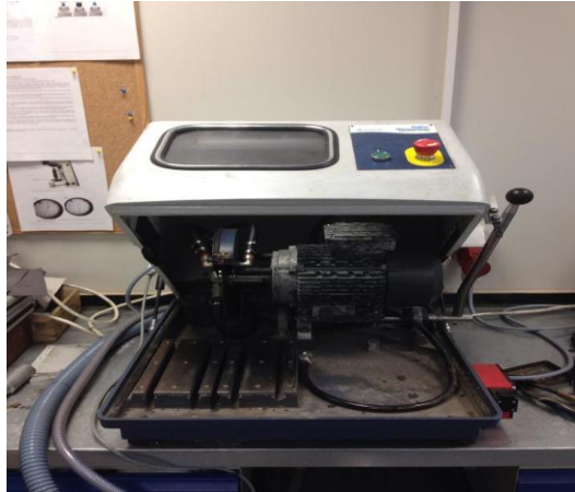
Joonis 17. Abrasiivlõike seade, Buehler Delta abrasiivmet/ abrasive cutter
