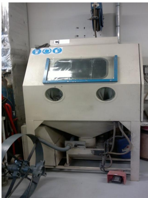
Joonis 10. Tallinna Tehnikakõrgkooli pindamislaboris kasutatav liivaprits ILB 120.
