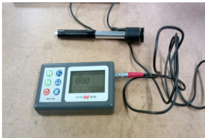
Joonis 16. Kroomterasest pinde kõvaduse mõõtmiseks kasutatud seade Wilson Wolpert WHU-330
