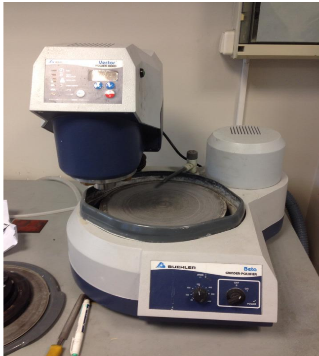
Joonis 19. Lihvimis- ja poleerimismasin, Buehler Beta grinder -polisher
