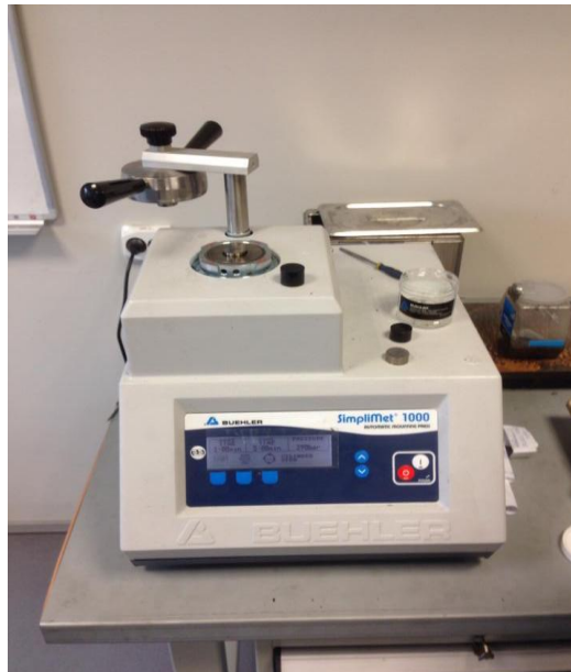
Joonis 18. Kuumvormipress Buehler SimpliMet 1000
