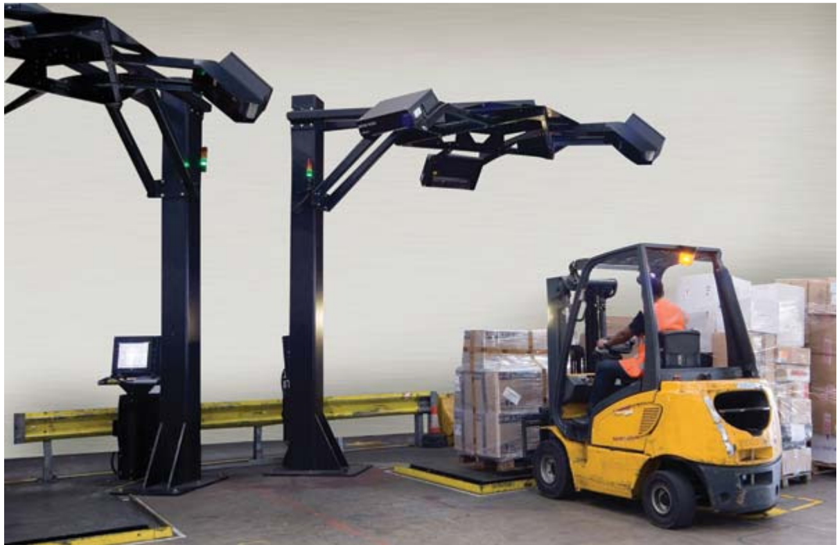
Pilt 3. Automaatne aluste mõõtmise süsteem
