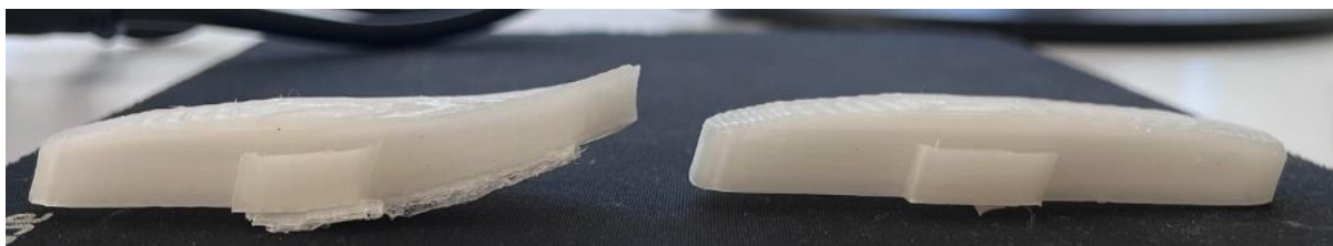
Joonis 33. Vasakpoolne detail kaardunud, parempoolne õigesti prinditud
