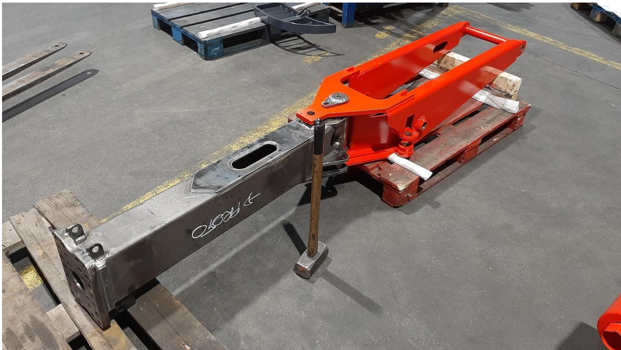
Pilt 7. Esimene prototüüp. Kahe keeviskoostu katse koostamine.
