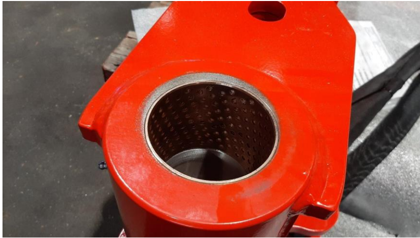
Pilt 12. Puksi (Lisa 3) sisemisele avale on jäetud töötlusvaru, et peale koostu keevitamist on võimalik töödelda lõpliku mõõdu peale. Seejärel paigaldatakse pressistuga liuglaager (Lisa 2).
