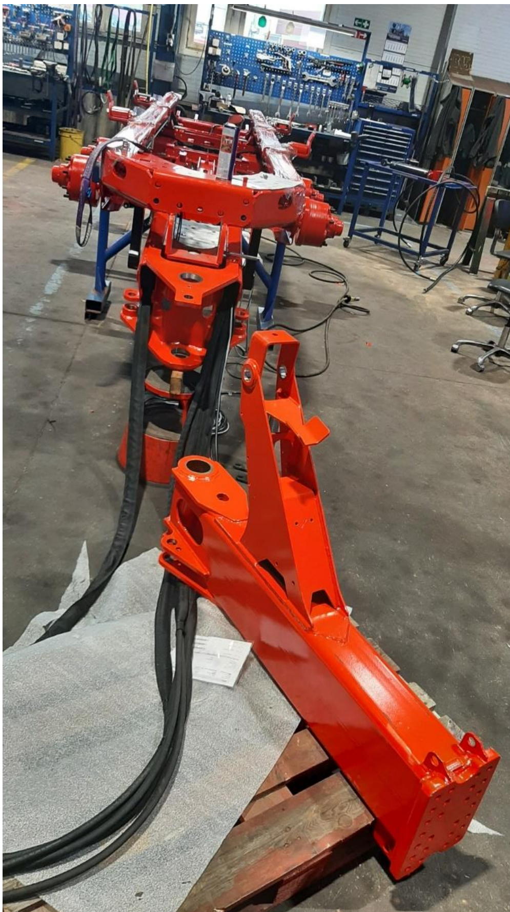
Lisa 14. Hüdrovoolikute paigaldamine
