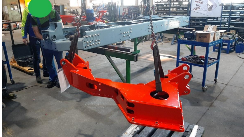
Pilt 15. Kraana kasutamine B12 haagise koostamisel
