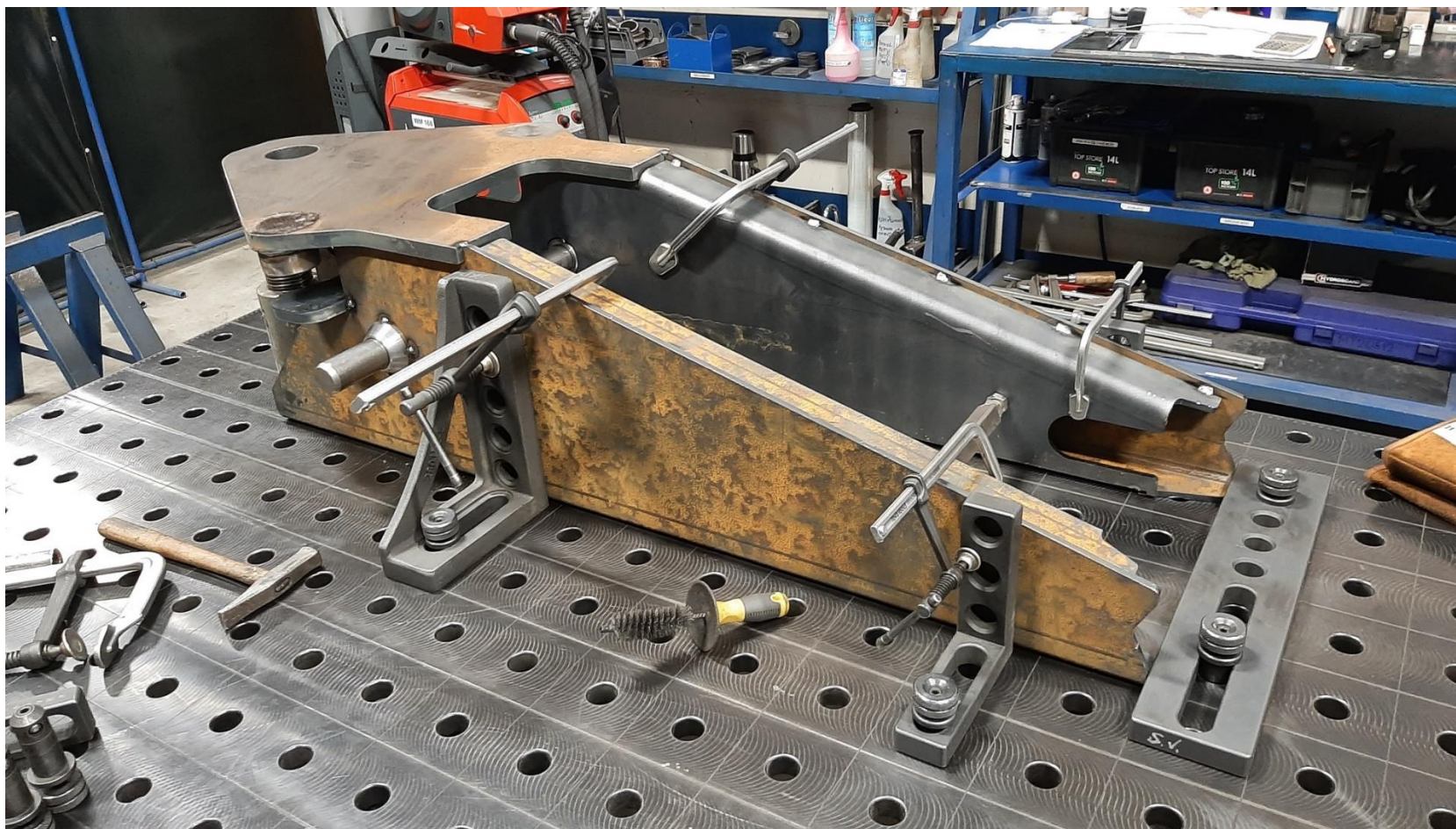
Lisa 10. Tagumise osa koostamine keevituslaual. Tarvis läheb ainult elementaarseid tööriistu.
