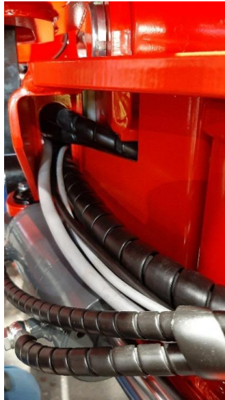
Pilt 8. Hüdraulika voolikute ja elektrijuhtmete kulgemine läbi külgedel olevate avavuste
