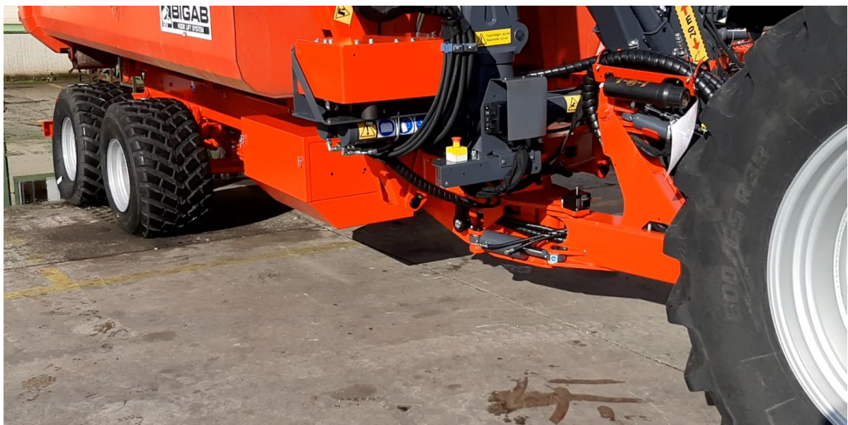
Pilt 20. Pööramise katsetamine. Pildil on näha rehvide külgsuunalist nihet.
