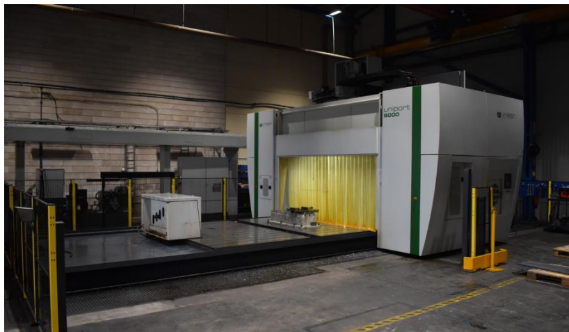
Pilt 14. UNIPORT 6000. Selles CNC masintöötluskeskuses teostatakse töötlus ka veotiislile.
