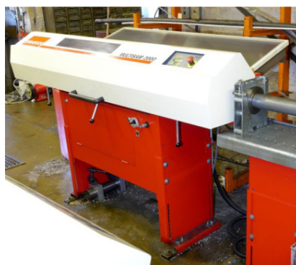
Sele 3 Samsys multisam 2000 tooriku etteandmismehhanism
