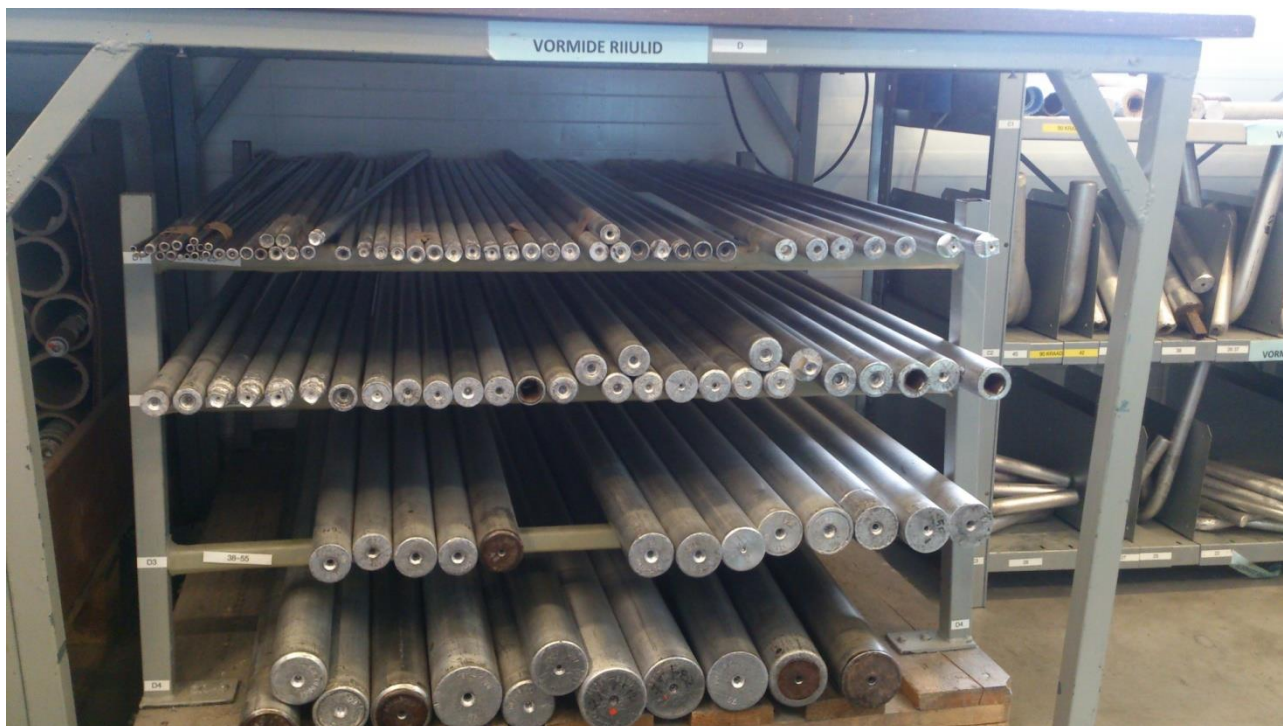
Joonis 11. Sirgete voolikute valmistamiseks kasutatavad alumiiniumvormid
