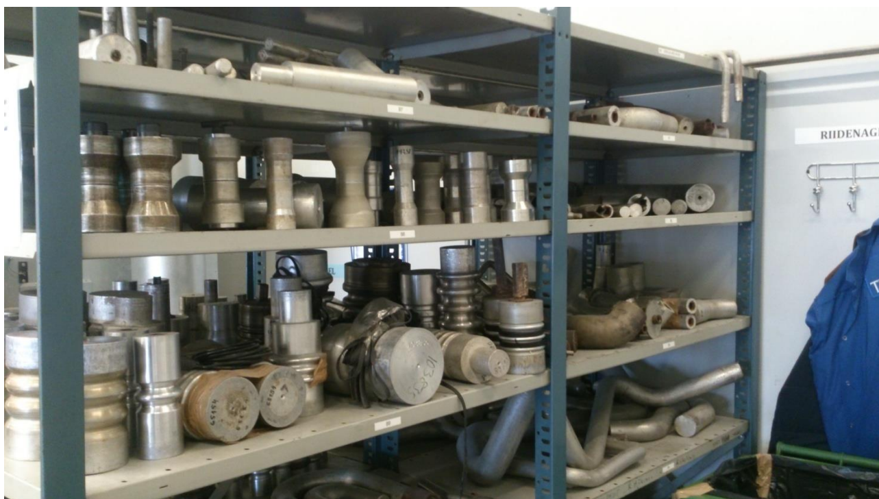
Joonis 12. Erikujuliste silikoontorude valmistamiseks kasutatavad alumiiniumvormid
