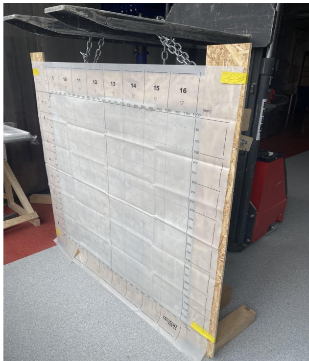
Foto 5. Katsekeha ettevalmistus Hilti PS 1000 X-Scani jaoks
