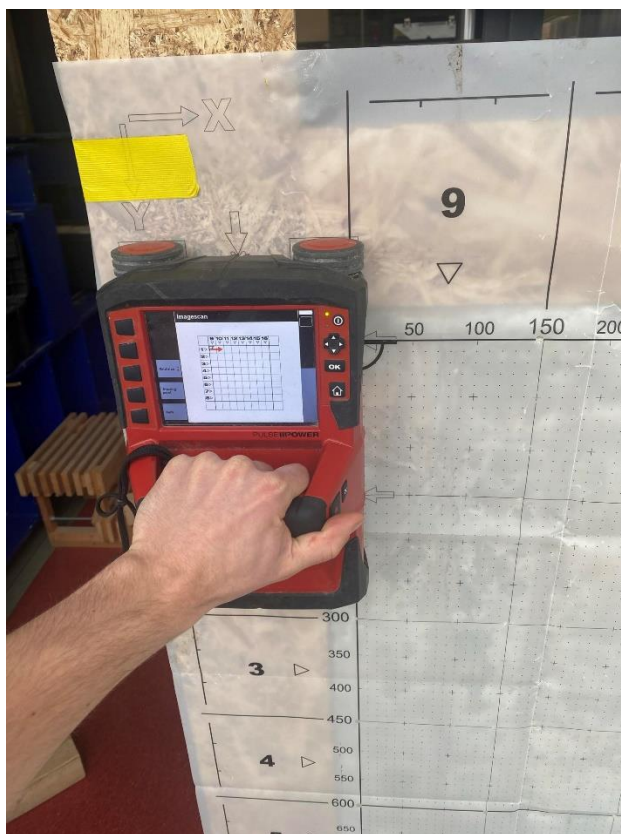
Foto 6. 3D Scan mõõdistamine Hilti PD 1000 X-Scan seadmega
