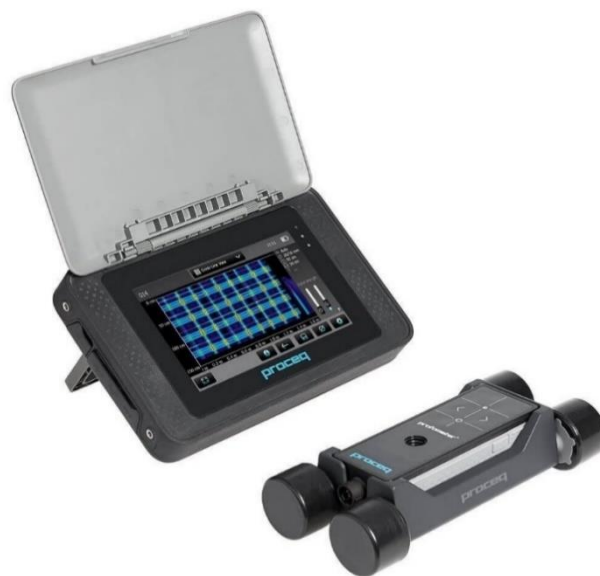
Joonis 9. Proceq Profometer 600 [22]
