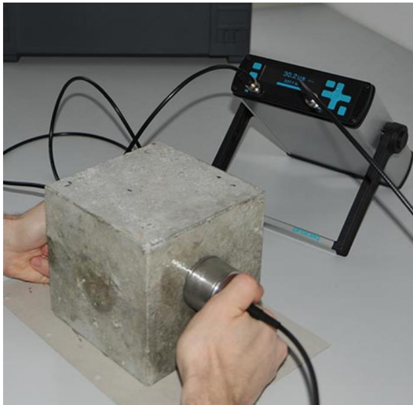
Joonis 4. Ultraheliimpulsi mõõteseade Proceq Pundit Lab (+) [11]
