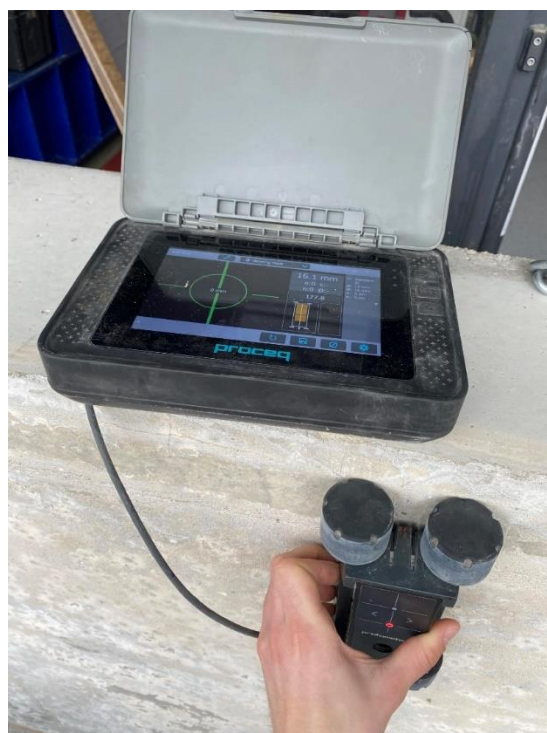
Foto 4. Mõõtmise Proceq Profometer 600 seadmega
