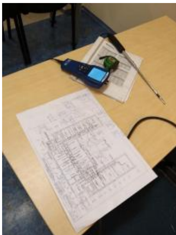
Pilt 4. Ventilatsiooni mõõtesead
