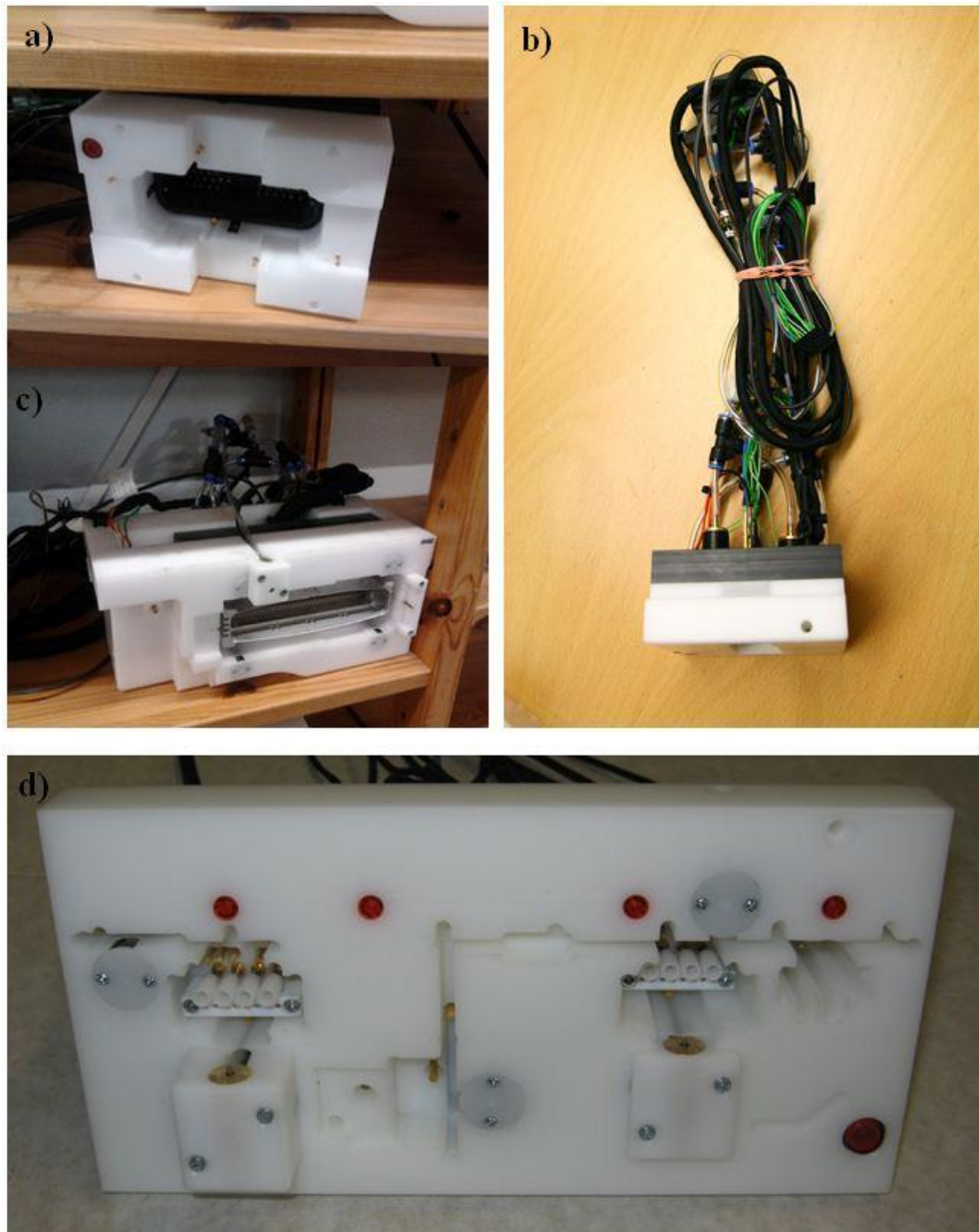
Joonis 4. Erinevat tüüpi testpesade näidised: a – pistiku kaane testidega testpesa; b – kahest osast koosnev testpesa; c – liikuva osaga ja alumiinium FM huulikuga testpesa; d – testpesa mitme pistikuga raami testimiseks
