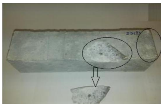
Foto 5. Proovi (Segu III) pildid pärast 56 päevast säilitamist 1 M NaOH lahuses [13]
