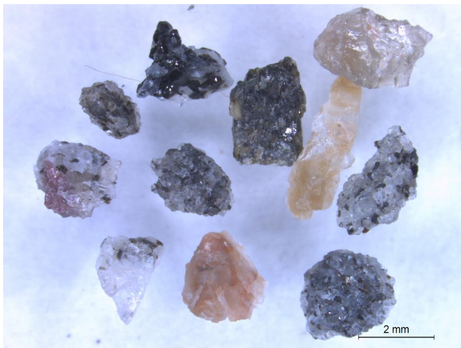
Foto 73. Lõugpurustiga purustatud Parainen karjääri jämetäitematerjal, fraktsioon 2...1 mm
