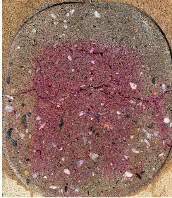
Foto 60. Objekt 5 samba katsealune pind pärast roosa pigmendi kasutamist, arenenud ASR-i ei tuvastatud
