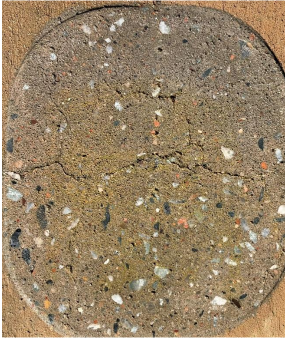
Foto 59. Objekt 5 samba katsealune pind pärast kollase pigmendi kasutamist, algaasis ASR-i ei tuvastatud
