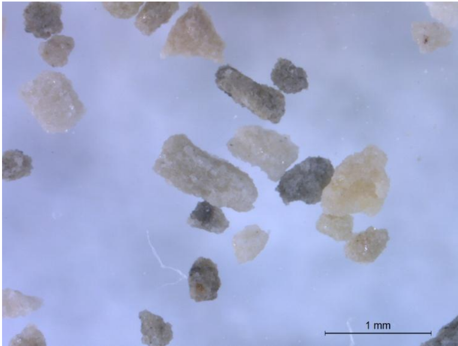
Foto 71. Lõugpurustiga purustatud Anelema karjääri jämetäitematerjal, fraktsioon 0,50...0,25 mm
