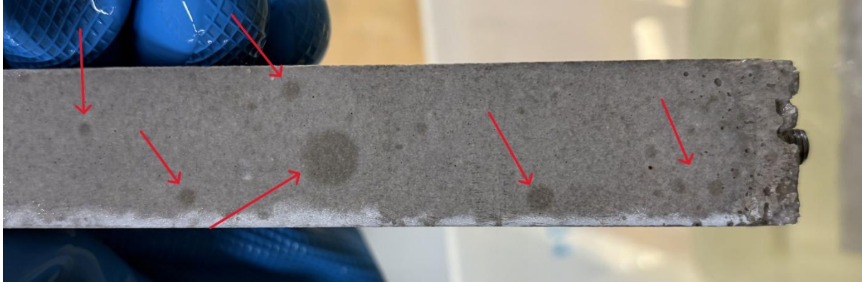
Foto 29. Väo katsekeha 21. päeval, nooled viitavad tumedatele laikudele katsekeha pinnal
