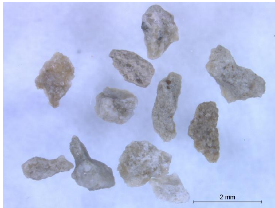
Foto 82. Lõugpurustiga purustatud Lõuna-Aru karjääri jämetäitematerjal, fraktsioon 1,0...0,5 mm
