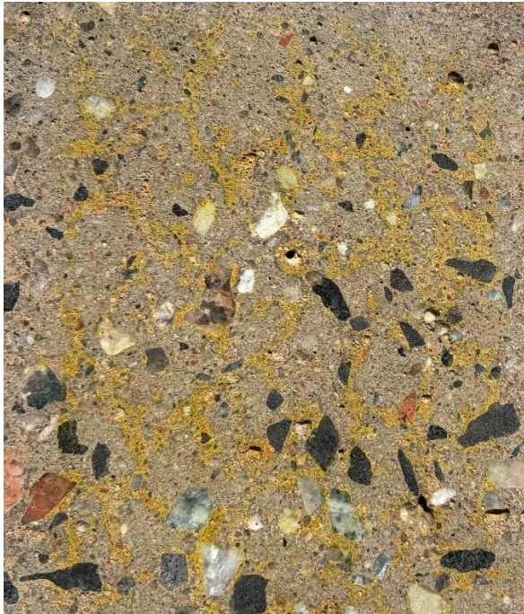
Foto 45. Kollase pigmendi jäljed pragunemise kohtades ning peen- ja jämetäitematerjali terade ümbruses
