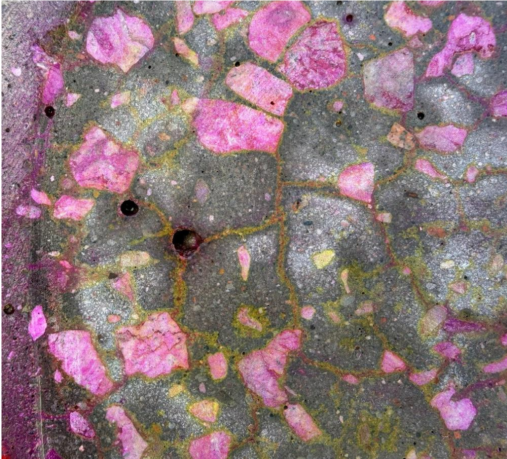
Foto 43. Kollase ja roosa värvaine jäljed betoonpostil, märgata on nii kollase kui ka roosa värvaine jälgi pragudes ja terade kontuuril
