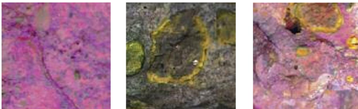
Foto 33. Vasakult paremale: ainult roosa reageeriva ainega testitud betoonpind ulatuslikke ASR kahjustustega, ainult kollase reageeriva ainega testitud betoonpind algaasis ASR-ga, kollase ja roosa värvainega testitud betoonpind nii algaasis kui ka arenenud ASR-ga [35]
