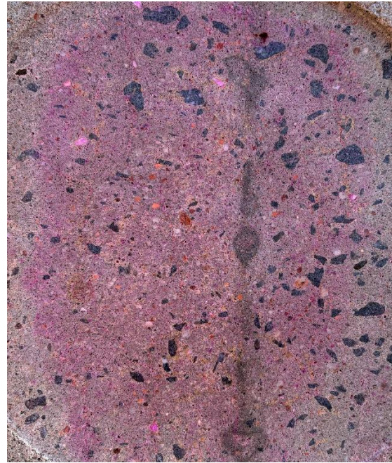
Foto 56. Uuritav pind pärast roosa pigmendi maha pesemist, viitab arenenud ASR puudumisele
