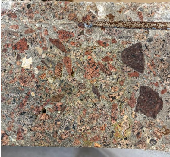
Foto 38. Kollasest värvainest puhastatud Sõpruse silla tala fragment, millel puuduvad algvaasis ASR-le iseloomulikud värvimuutused
