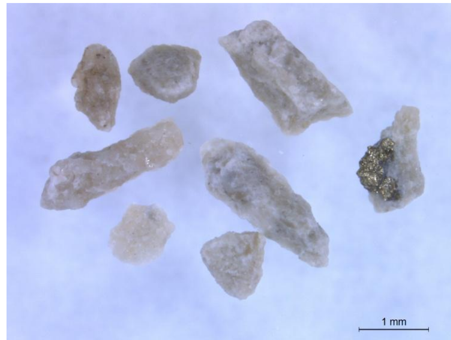
Foto 78. Lõugpurustiga purustatud Harku karjääri jämetäitematerjal, fraktsioon 1,0...0,5 mm
