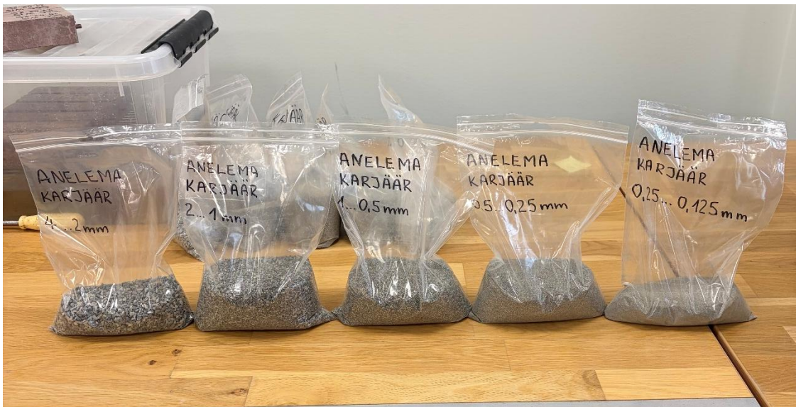
Foto 23. Purustatud ja fraktsioneeritud killustiku säilitamine
