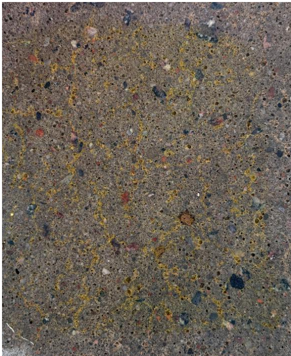
Foto 50. Objekt 3 servaprussi ülemise osa pind pärast kollase pigmendi maha pesemist, pigem ei esine algaasis ASR-i
