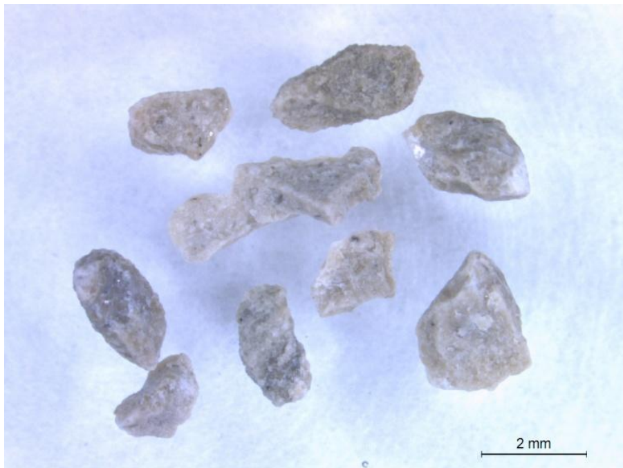
Foto 77. Lõugpurustiga purustatud Harku karjääri jämetäitematerjal, fraktsioon 2...1 mm
