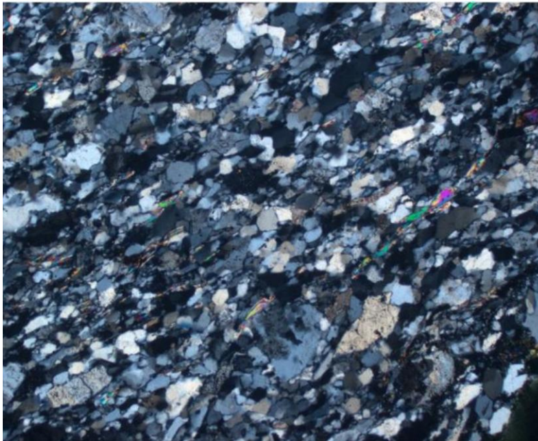
Foto 18. Väga suure tõenäosusega reaktiivne Rootsi peenteraline müloniit ( fine-grained mylonite ) [14]
