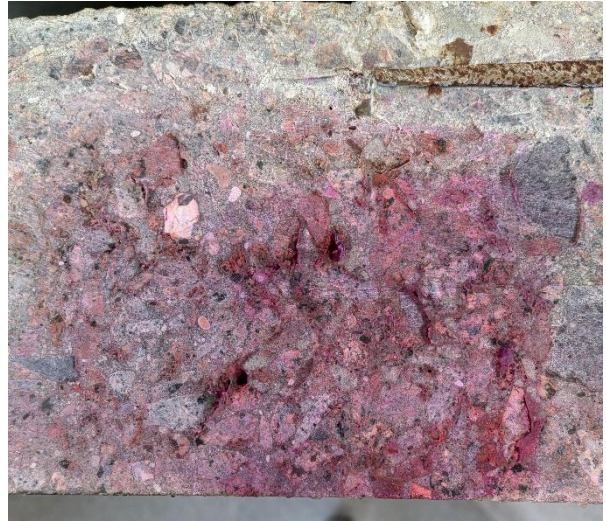
Foto 39. Roosast värvainest puhastatud Sõpruse silla tala fragment, millel puuduvad arenenud ASR-le iseloomulikud värvimuutused
