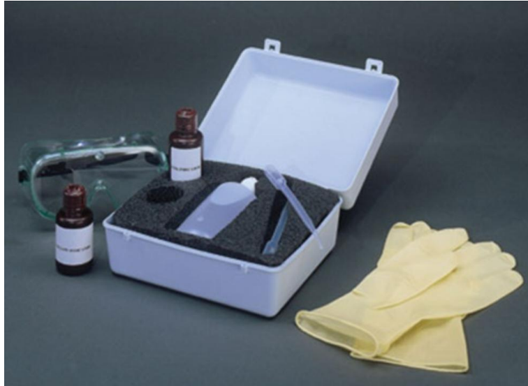
Foto 32. James Instruments ASR Detect komplekt [34]
