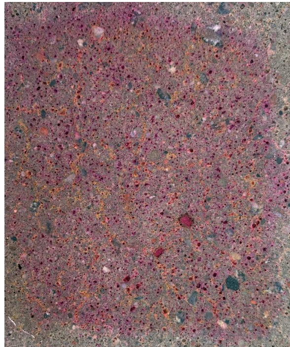
Foto 51. Objekt 3 servaprussi ülemise osa pind pärast roosa pigmendi maha pesemist, pigem ei esine arenenud ASR-i
