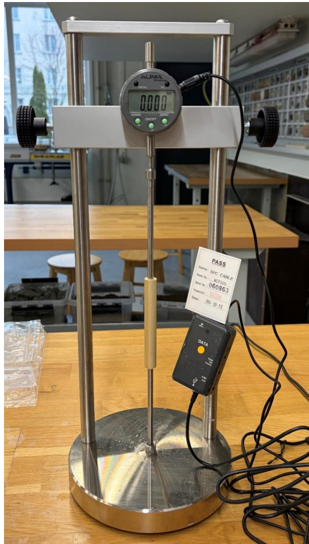
Foto 27. Controls Length Comparator mõõteseade koos SPC MCP105 kaabli ning referentspulgaga
