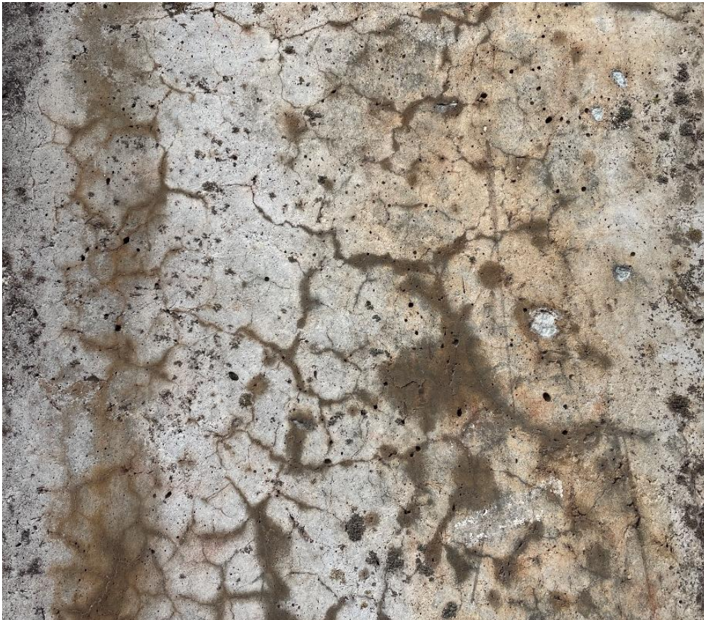
Foto 40. Betoonposti pind enne ASR katset
