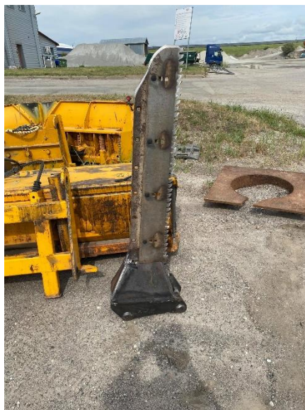
Foto 1. Kopplaaduri lisatarvik puujuurte lõikamiseks
