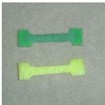
Joonis 4.2 Katsekehade kujud Lubramidist ja Oilamidist
