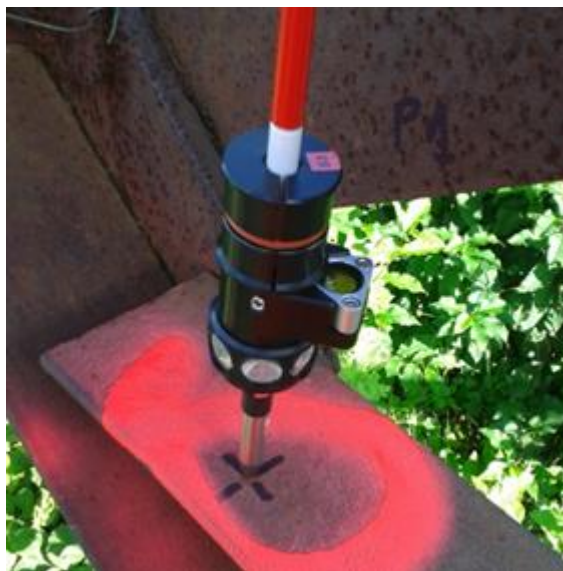
Foto 1. Mõõdistusvõrgu punkt P1 metallelektriposti küljel (autori foto)
