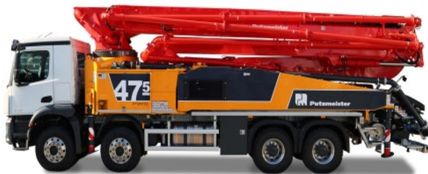
Foto 2. Betoonipump putzmeister 45,5 m [12]
