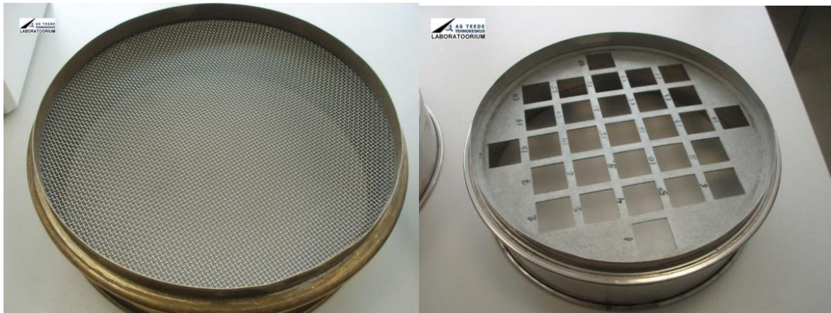
Foto 1. EVS EN 933-1 puhul on kasutuses ruutavaga ja võrksõelad [Erakogu]
