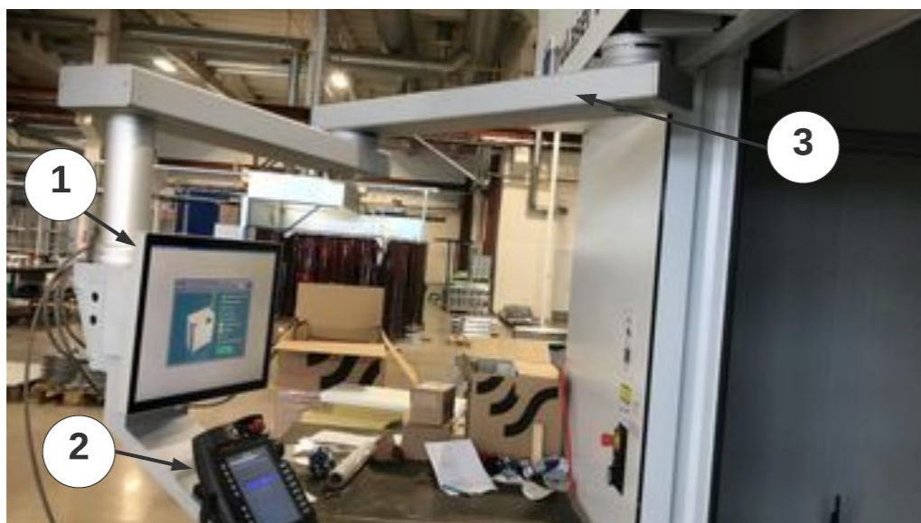
Joonis 18. Tööstuslik arvuti ekraani kinnitus seinale: 1 – arvuti ekraan, 2 – juhtimisseade, 3 – reguleeritav lüli
