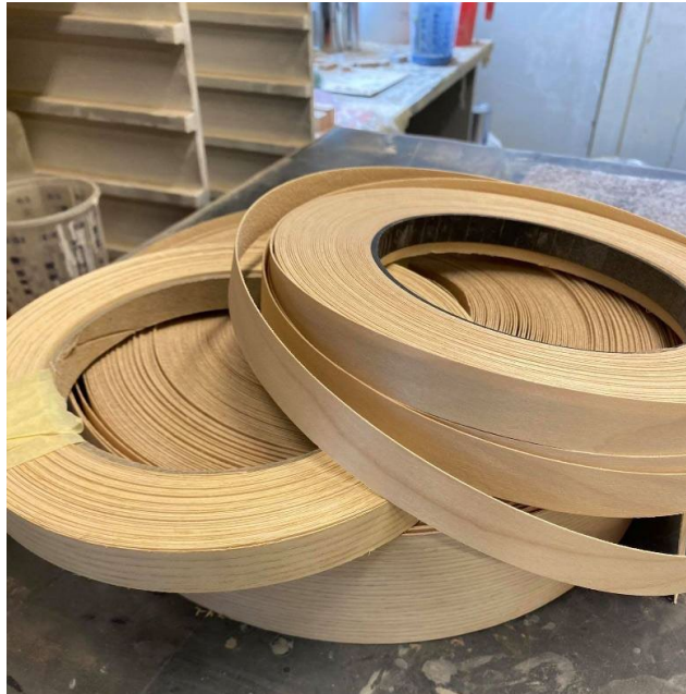
Joonis 20. Puidust spoonkant
