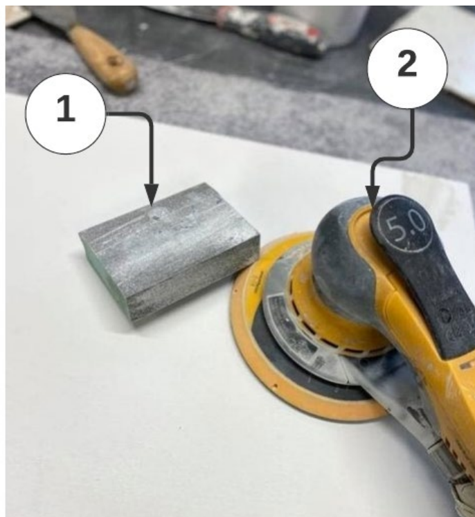
Joonis 21. Lihvimistarvikud: 1 – lihvimisklots, 2 – eksentriklihviija
