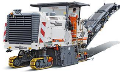
Foto 11. Asfaldifrees Wirtgen W 1900 [10]
