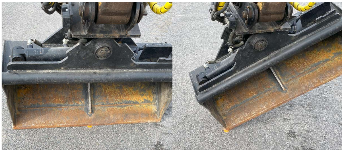
Foto 7. Punkti kontroll ekskavaatori kulbi keskkohaga (vasakul) ja nurgaga (paremal)
