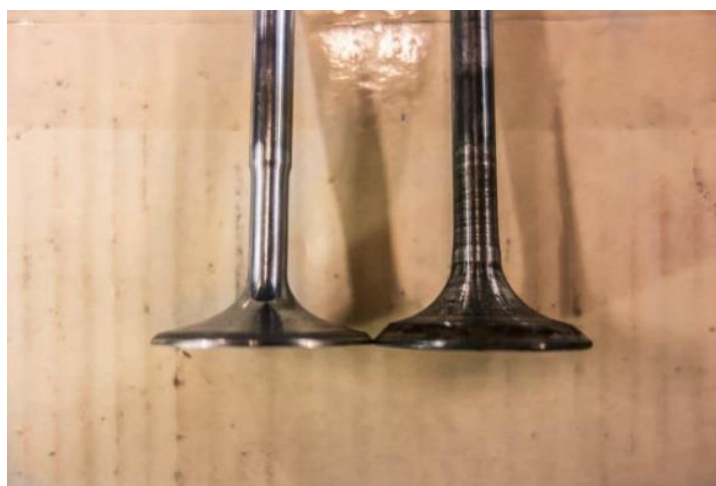
Sele 5. Modifitseeritud vs tehase sisselaskeklapp [9]
